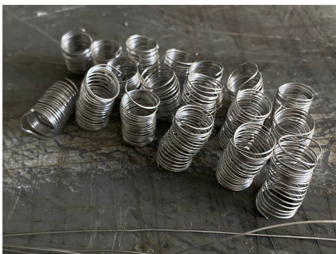
Рис. 1. Образцы из сплава 8176, скрученные в пружину, для измерения изменения массы после выдержки в корродирующих средах
