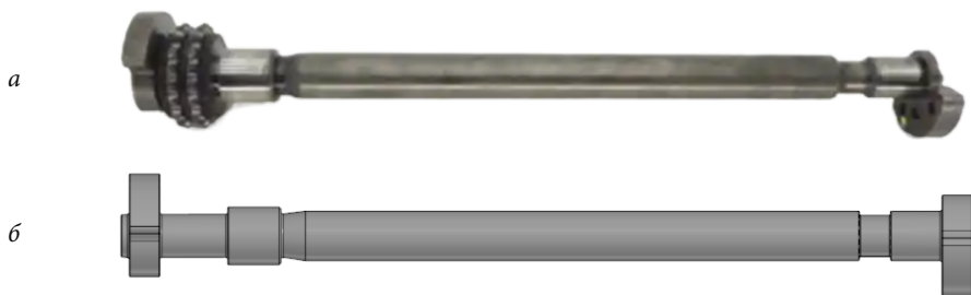
Рис. 10. Балансирный вал рассматриваемого двигателя (а) и его твёрдотельная модель (б), полученная в результате расчетов
